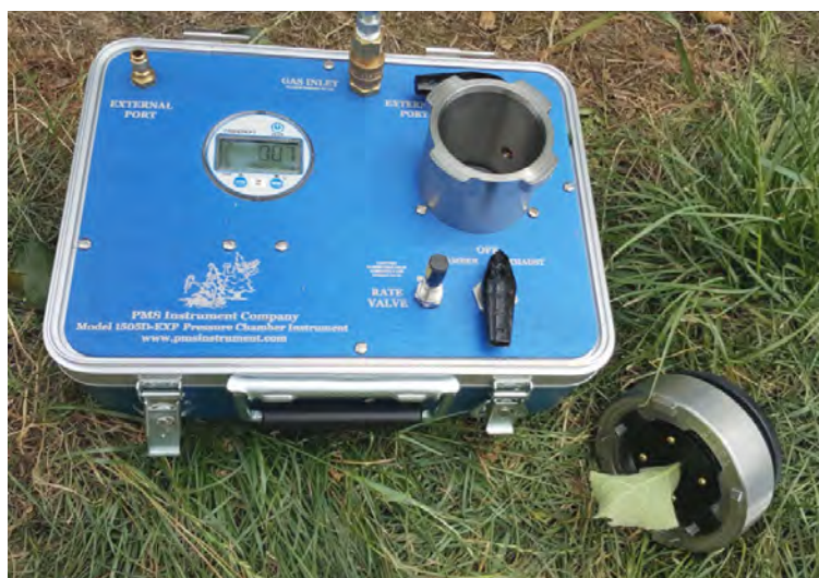
Obrázek 16. Scholanderova tlaková komora pro měření vodního potenciálu. Vpravo dole je list fixovaný ve víku tlakové nádoby.
