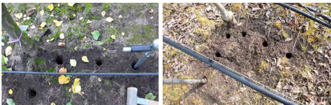
Obrázek 30. Odběr vzorků půdy s kořeny půdním vrtákem (sondýrkou) v různých vzdálenostech od kmene stromu
