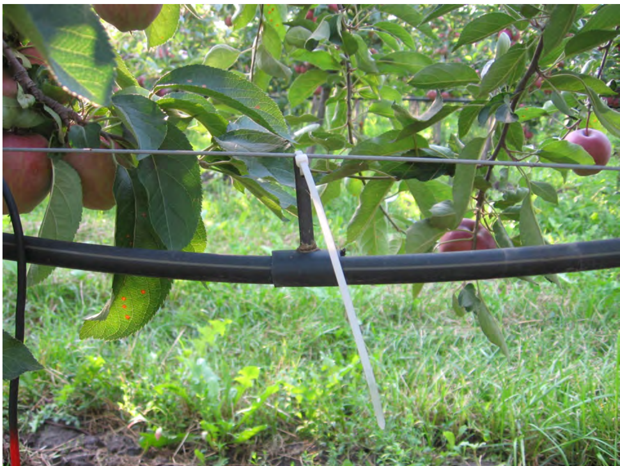
Obrázek 7. Detail zajištění prohnutí kapkovací hadice nad umístěním snímačů vlhkosti půdy
