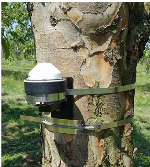
Obrázek 19. Automatický (nahore) a manuální (dole) páskový dendrometr nainstalovaný na kmeni jabloně
