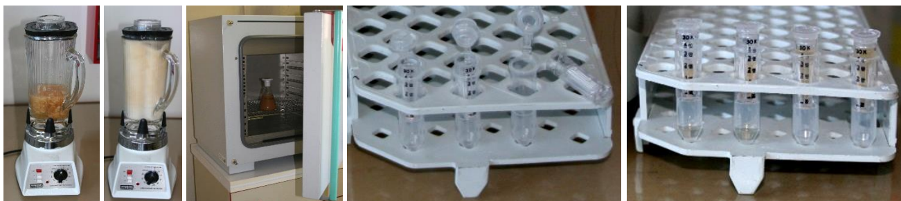
1. Příprava k homogenizaci vzorků ovoce 2. Vlastní homogenizace 3. Termostat se vzorky 4. Filtry Amicon 5. Vzorky po centrifugaci (vlevo), vzorky před centrifugací (vpravo)
