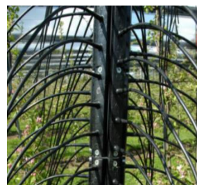
Detail pracovního vřetena stroje Darwin (foto: Fruit Tec Maschinenbau)
