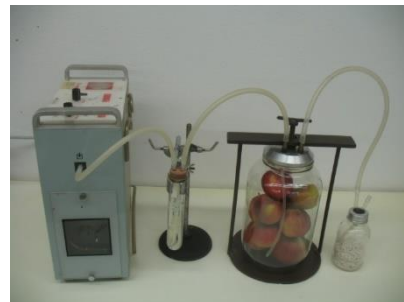
Aparaturní sestava pro absorpci oxidu uhličitého do hydroxidu barnatého odsáváním atmosféry z nádoby za konstantního průtoku vzduchu zbarveného CO 2 .
