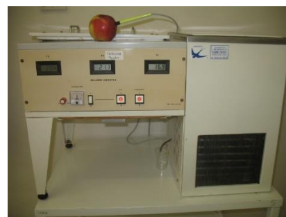
Zchlazovací tunel pro měření poločasu zchlazování dužnatých plodů
