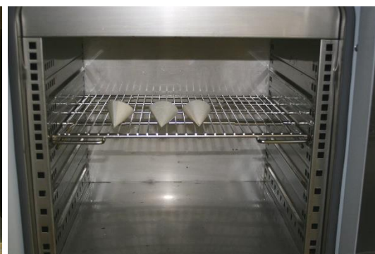
Sušení vzniklého filtrátu v sušárně na 120 °C
