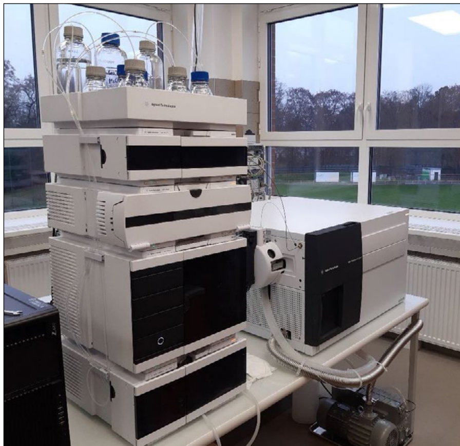
Obrázek 14 Stanovení obsahu cukrů a cukerných alkoholů. Systém UHPLC-MS - UHPLC Infinity II 1290 a Triple Quadropole 6470 Series, Agilent Technologies, Santa Clara, CA, USA
