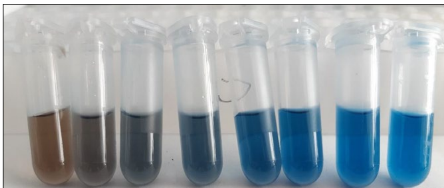
Obrázek 8 Stanovení obsahu proteinů. Roztoky standardu o různé koncentraci k sestavení kalibrační křivky.
