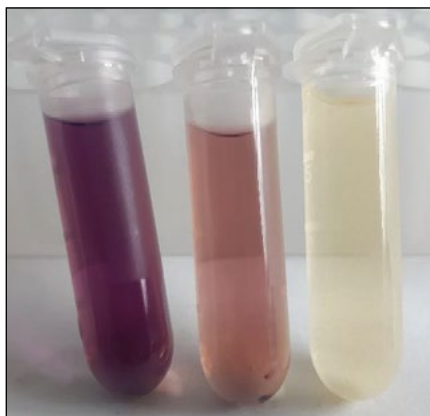
Obrázek 12 Stanovení celkové antioxidační aktivity. DPPH test – barevná změna DPPH v důsledku redukce volným atomem vodíku
