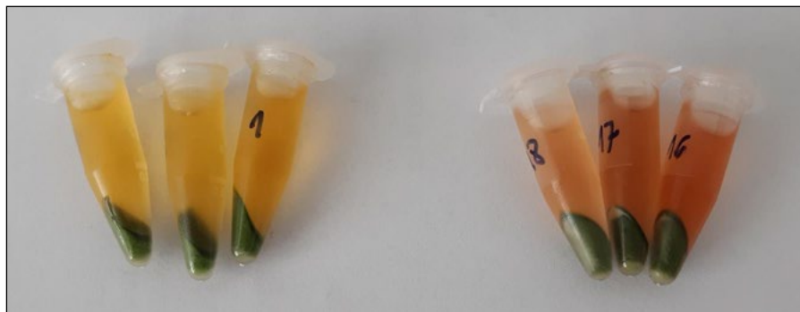
Obrázek 9 Stanovení obsahu reaktivních forem kyslíku. Vzorky připravené k měření absorbance pomocí spektrofotometru
