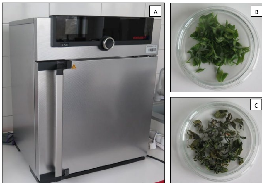
Obrázek 5 Stanovení relativního obsahu vody v pletivech. A - horkovzdušná sušárna Memmert UN30; B - segmenty explantátů připravené v Petriho misce k vysušení; C - vysušené segmenty explantátů po skončení sušení
